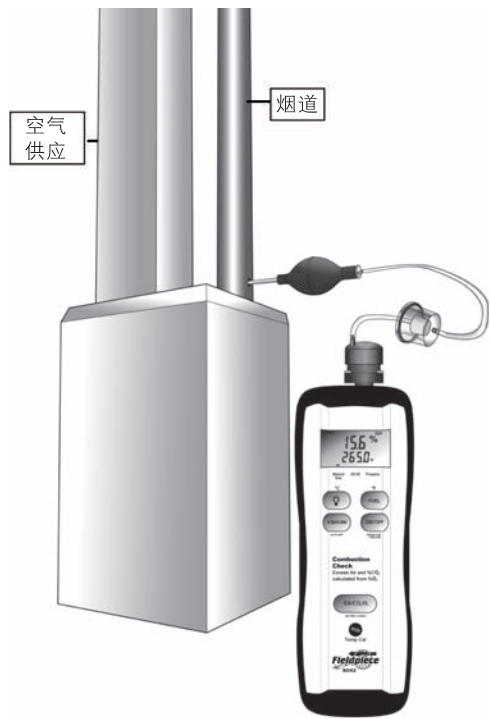
菲比斯 (Fieldpiece) SOX2 测量烟道内的 %O 2 含量和烟气温度。
