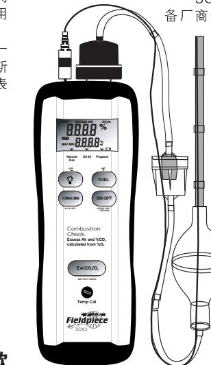
SOX2 让用户能够按照设备厂商规定的过剩空气 %、二氧化硫 ( CO ) 2% 和氧气 ( O2 ) %, 轻松校准锅炉或暖气炉等燃烧设备, 调节过剩空气、二氧化碳和氧气的温度参数和温度上升参数, 使其符合设备厂商的技术规格, 提高设备的能效、性能和预期使用寿命。典型调节方法是调节空燃比。
