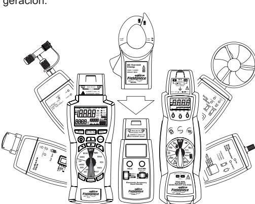
Los accesorios expansores (los sensores) envían una señal de mV, que representa el valor del parámetro a prueba. Los accesorios pueden conectarse directamente al tope del medidor tipo barra, registrador de datos DL3 o EHDL1. También se pueden conectar a cualquier medidor con rangos de mV mediante conductores ADLS2.
