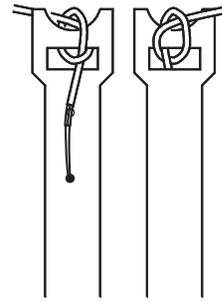
Dos correas de Velcro han sido incluidas con el ATH4 para hacer más fácil la medición de temperaturas de tubo. Use la correa de Velcro para sostener el extremo redondeado del termopar ATB1 modelo contra el tubo.
